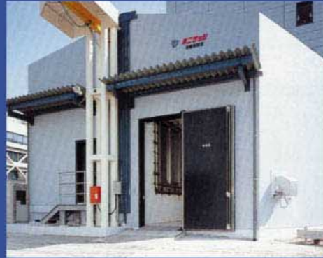
音響實驗室- 遮音性能測試 符合JIS Q17025(ISO17025) 規範：最大測試尺寸為 (W380 X H300CM)
